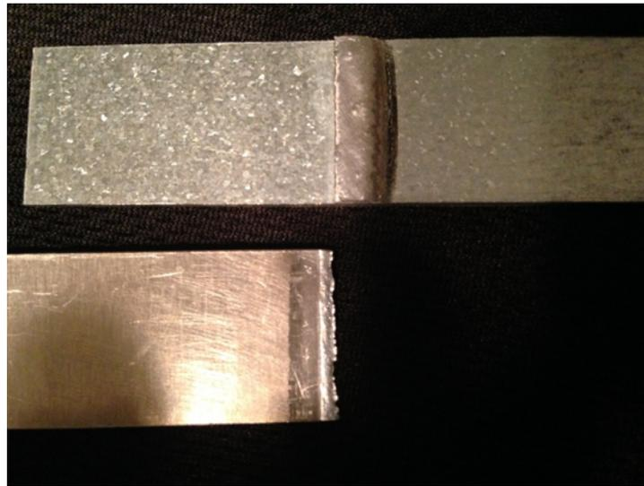
Figure 12 : Essai de traction, rupture dans la soudure adjacente à la plaque d'aluminium.
