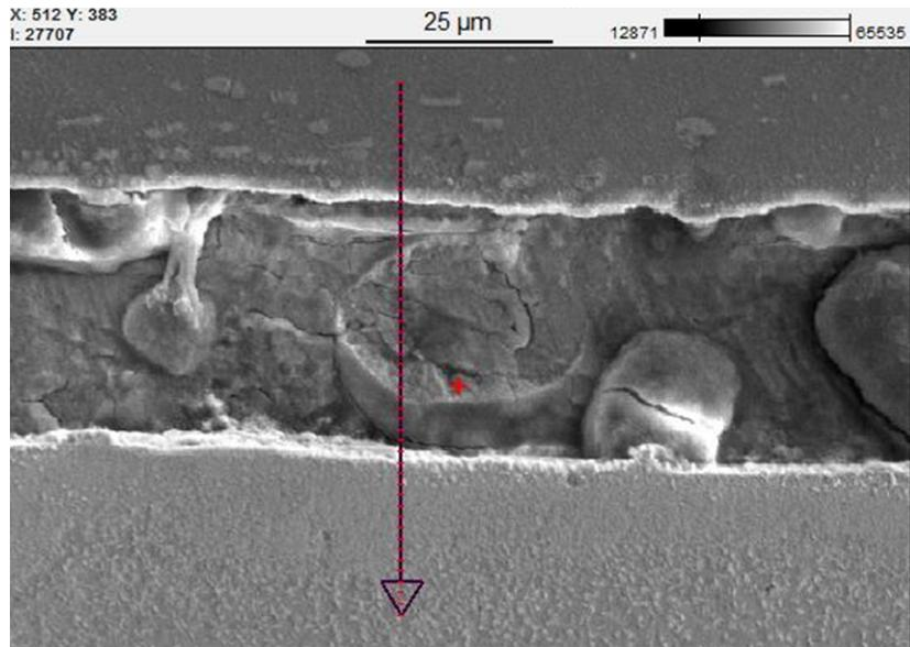
Figure 10 : Zone analysée au MEB (aluminium vers acier galvanisé)
