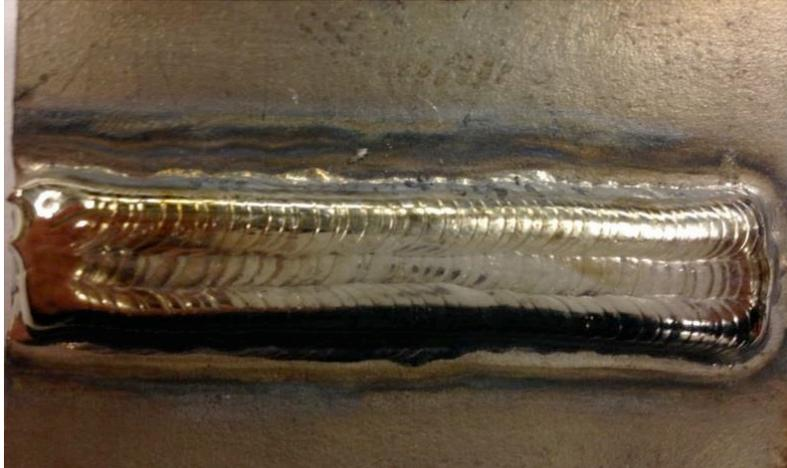
Figure 16 : Soudure titane GTAW, 19 passes pour un dépôt équivalent à celui en CMT
