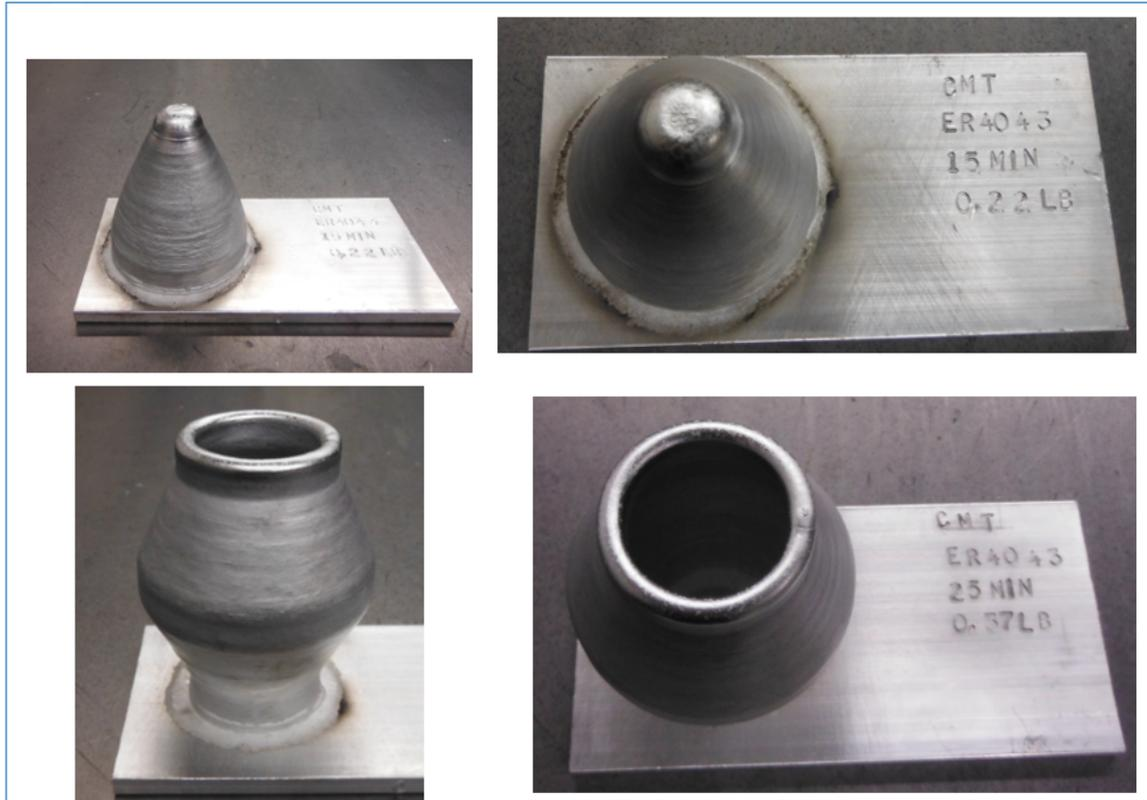
Figure 18 : Exemples de fabrication additive en aluminium
