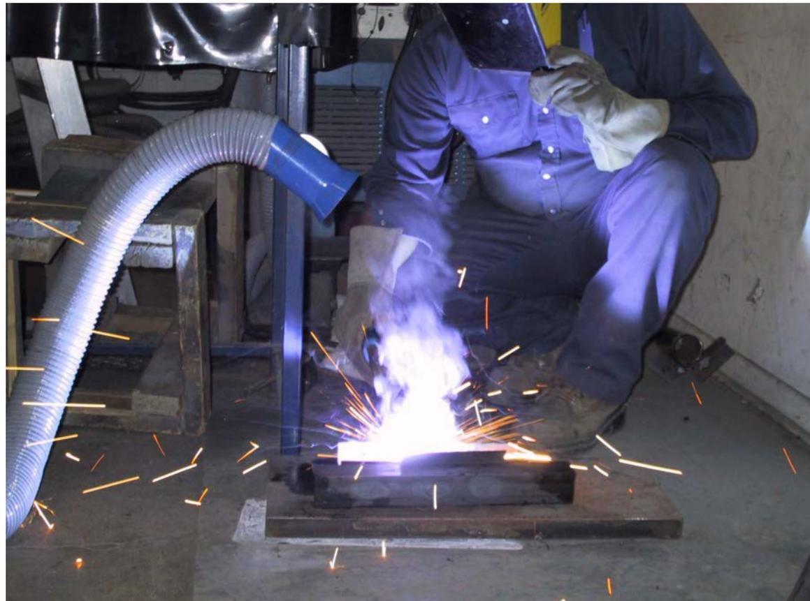
**Flexible 3 pouces avec buse de capitation 3'' maintenu en position par un aimant.
