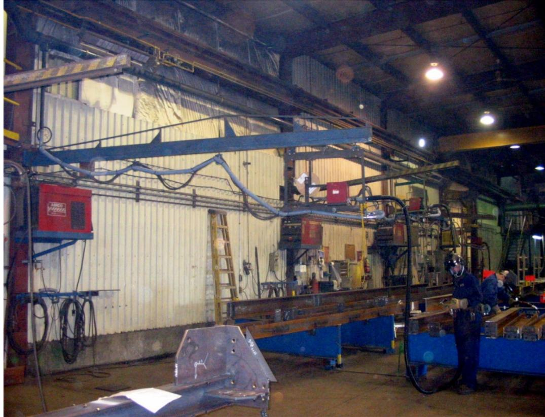
**Pistolet assisté par vacuum installé sur une potence qui tourne sur une colonne. Le dévidoire glisse le long de cette potence. Cet arrangement donne un grand rayon d'action au soudeur sans qu'il n'y est de câble ou de boyau sur le plancher. Cet arrangement est installé chez un fabricant de poutres d'acier.**
